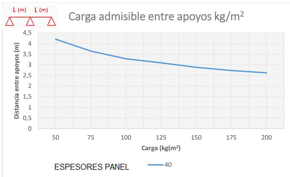
Las gráficas recogen las distancias máximas admisibles entre apoyos en función de la carga (uniformemente repartida) y del espesor del panel.
