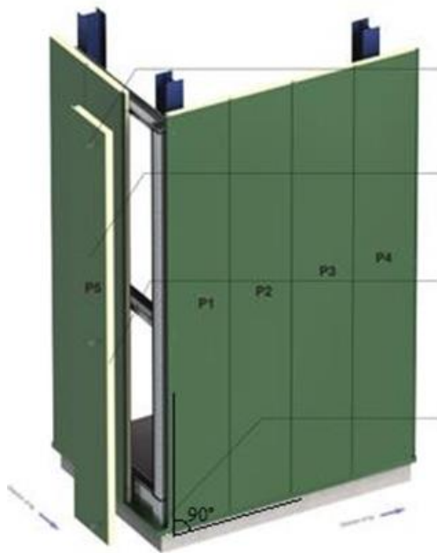
Ilustración 12: Vista general de colocación de panel de fachada vertical
